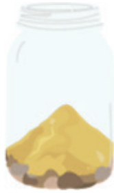
Figura 1: Adicionar cascalho ou pedras e uma camada de areia
