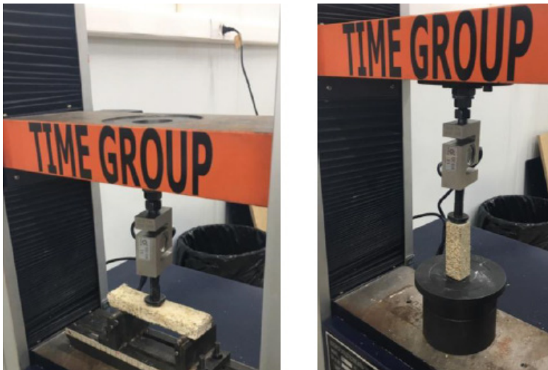
Figura 03- Máquina universal de ensaio sendo teste de compressão e flexão.
