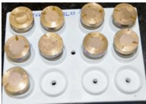
Figura 10 e 11: Amostras no metalizador após a metalização
