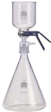
Figura 2 – Equipamento de filtragem do extrato enzimático
