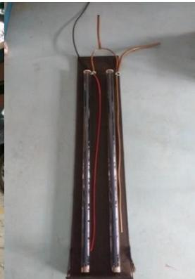
b) Coletores e tubos de cobre
