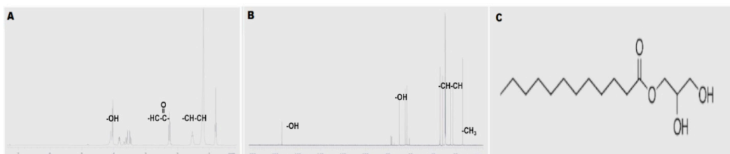
Figura 6 – Espectros do 1 H RMN (A) e 13 C RMN (B) do laurato de glicerila. (C) estrutura química sugerida para o laurato de glicerila (dodecanoato de 2,3-dihidroxi-propanoíla).
