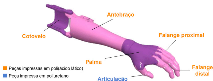
Figura 2 - Modelo 3D de prótese de membro superior Kwawu Arm v2.1.
