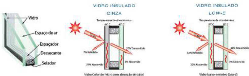
Figura 9 - Representação e esquema do vidro insulado termorregulador (Guardian Sunguard, s.d., p.8-9)
