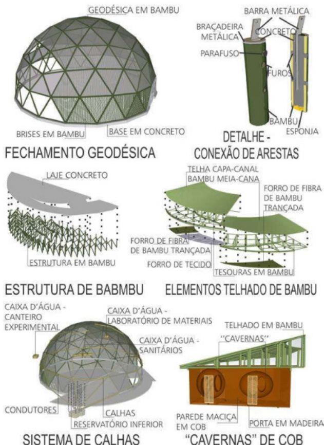
Figura 6. Elementos de terra e bambu (crédito: R. C. M. Alves, 2018)
