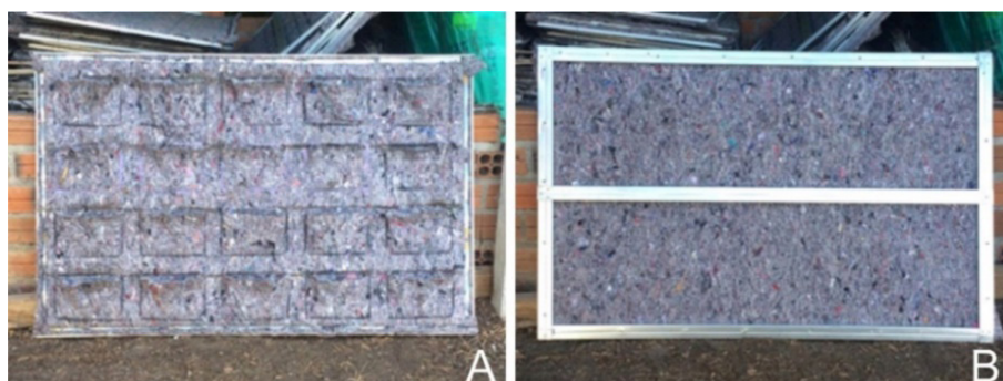
Figura 4 – Módulo confeccionado em feltro automotivo e perfis de aço zincado: (A) frente; (B) verso
