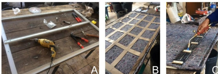
Figura 3 – Produção dos módulos: (A) Estrutura; (B) Marcação dos bolsos; (C) Chamuscamento
