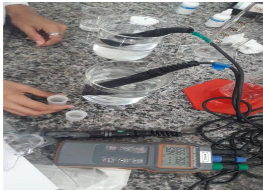
Figura 6: Análise da água, utilizando o multiparâmetro de análise de água no laboratório
