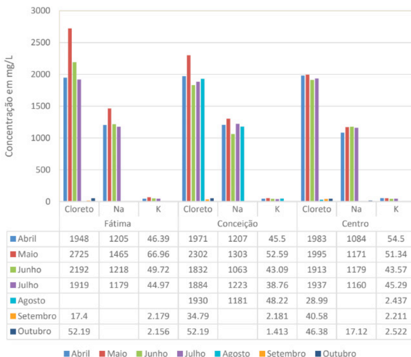
Figura 1- Concentrações (mg L -1 ) de cloreto, sódio e potássio nas águas do abastecimento público coletadas em Itabuna-BA.
