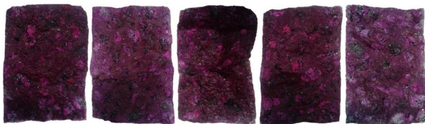
Figura 2 - Fotografia do ensaio de carbonatação das amostras do Rio Doce A1, Rio Doce A2, Pancas, Santa Maria e Santa Joana, da esquerda para direita, respectivamente.
