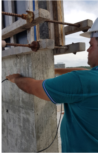
Figura 9 - Realização do ensaio de ultrassom
