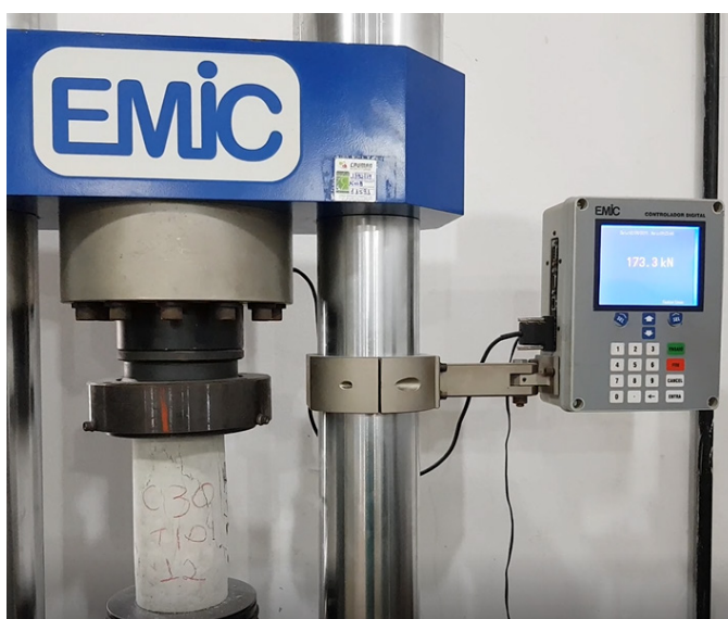
Figura 7 – Execução do ensaio à compressão
