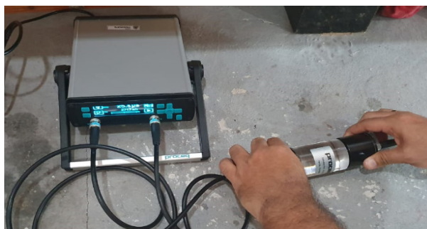
Figura 4 – Calibração do ultrassom
