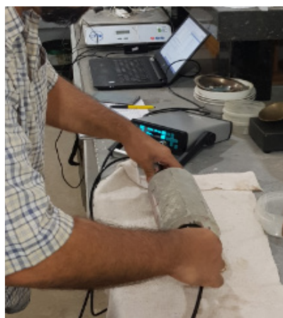
Figura 5 – Realização de ensaio de pulso ultrassônico
