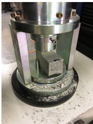
Figura 5 – Detalhe do ensaio de resistência à compressão axial
