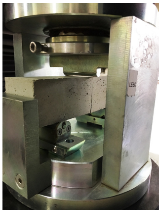
Figura 6 – Detalhe do ensaio de resistência à tração na flexão
