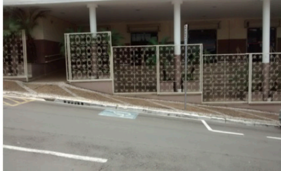
Figura 7: Acima: Matão. A vaga reservada para PCD está implantada em frente à garagem de uma edificação particular. À esquerda: Araraquara (vaga implantada em pavimento trepidante, ausência de faixa de transferência, rebaixamento e passeio irregulares. À direita: São Carlos (vaga implantada em via estrutural de fluxo intenso e alta velocidade, com declividade acentuada). Fotos das autoras.
