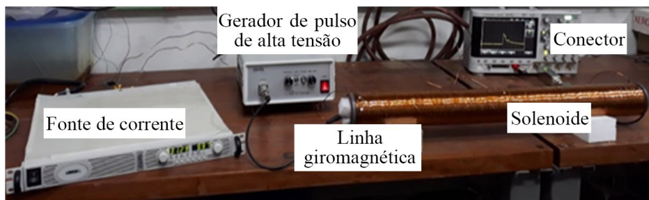
Figura 2 – Arranjo para teste de uma linha giromagnética coaxial usando solenoide como fonte do campo axial externo. [Yamasaki, et al. 2019]
