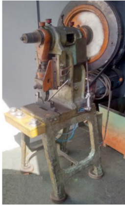
Figura 8: Prensa Excêntrica, após a melhoria
