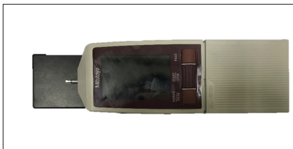
Figura 2.6.1: Rugosímetro Mitutoyo SJ-210
