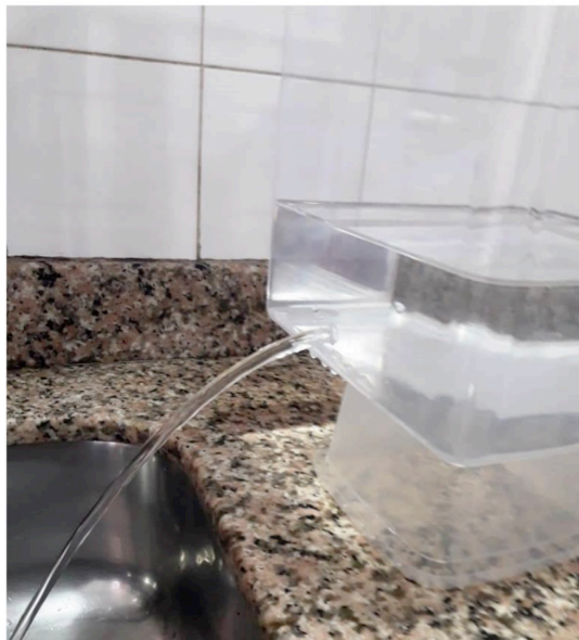
Figura 6 – Alcance do jato de água diminuindo simultaneamente à coluna de água
