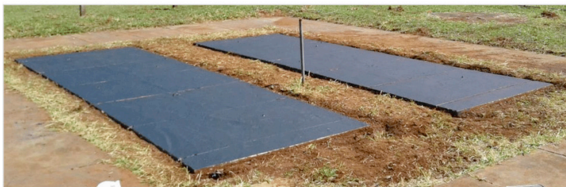
Figura 1 - Coletor Solar Experimental de Concreto.
