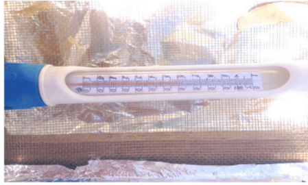
Figura 6 – Verificação de temperatura do desidratador
