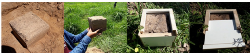
Figura 1: Método de coleta indicado pela literatura, acondicionado em caixas de MDF.
