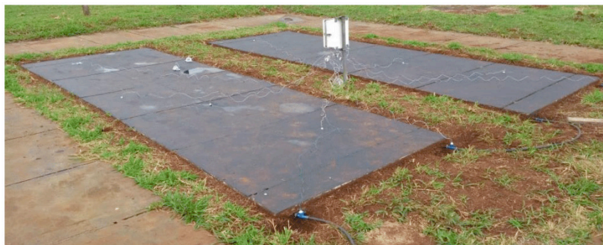
Figura 4 - Coletor Solar de Concreto em Operação.
