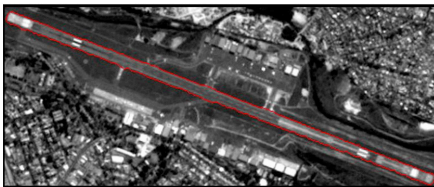
Figura 9 – Sobreposição da borda na imagem original do aeroporto Carlos Drummond de Andrade
