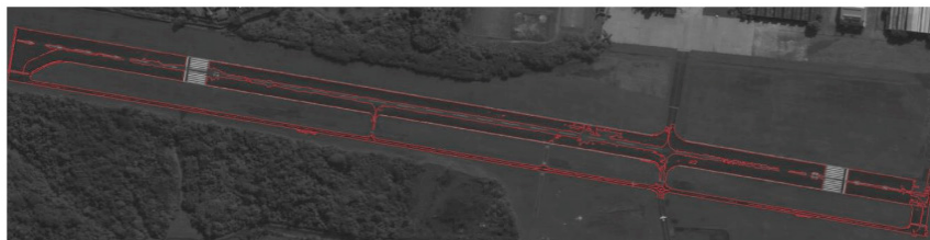
Figura 8 – Sobreposição da borda com a imagem original do aeroporto de Campo de Marte
