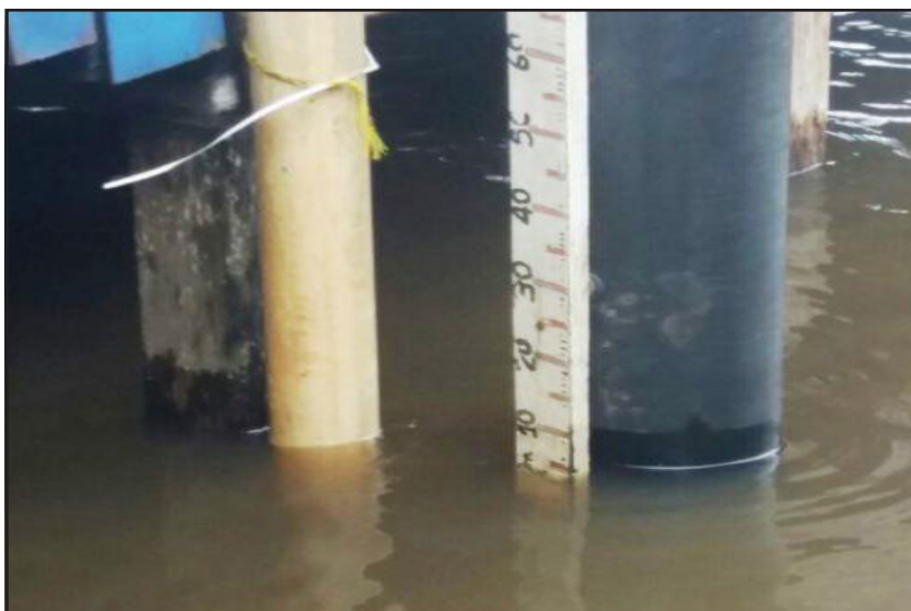
Figura 5 - Ponto de observação da régua instalada pela Defesa Civil.
