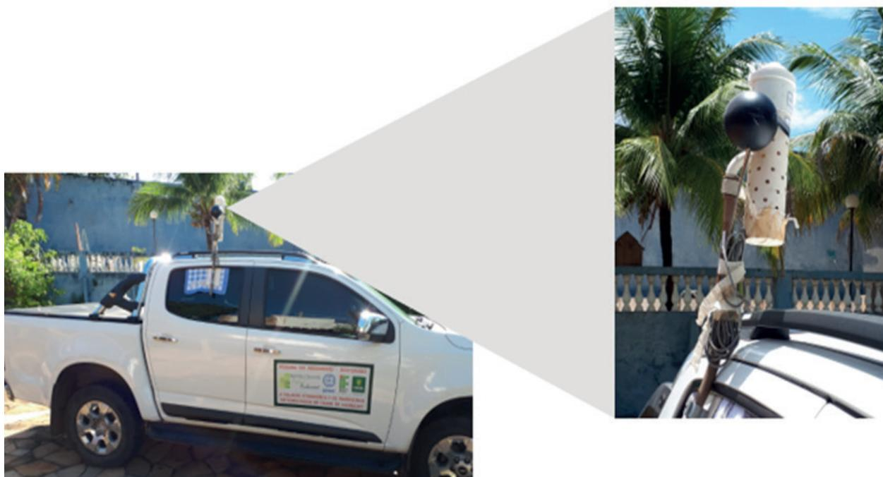
FIGURA 23 - Foto do Veículo Utilizado no transecto Nordeste-Sudoeste. Com detalhe do termômetro de globo.
