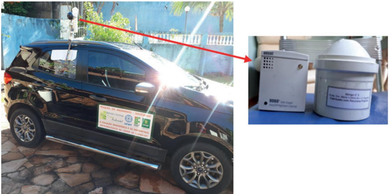
FIGURA 24 - Foto do veículo utilizado no transecto móvel Sudeste-Noroeste, do sensor datalogger utilizado na medição e parte do abrigo.
