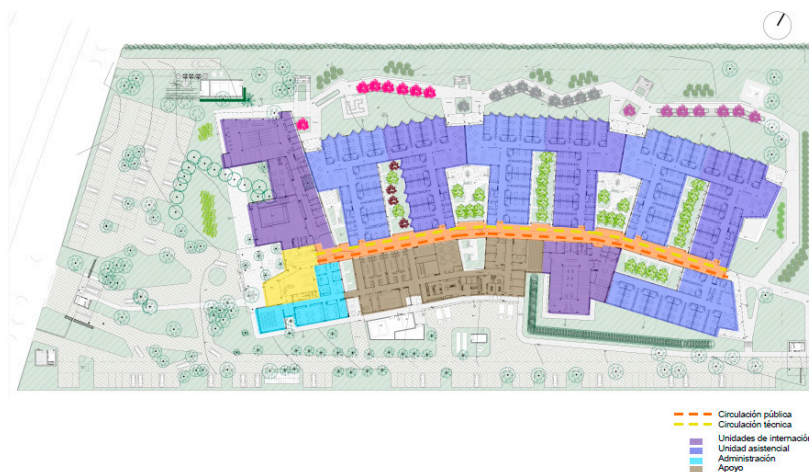
Planta baja – Organización funcional y circulatoria
