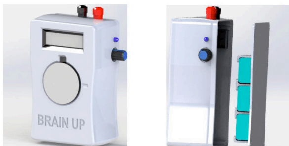
Figura ilustrativa 19: Estimulador Transcraniano por Corrente Contínua desenvolvido.
