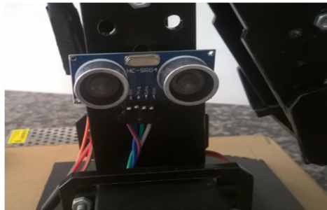
Figura 9. Sensor Ultrassônico instalado na parte inferior do braço
