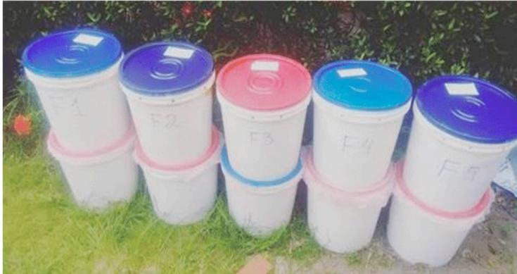
Figura 1 – Composteiras instaladas na unidade de compostagem
