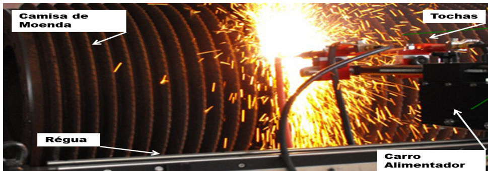
Figura 3 - Conjunto utilizado para realização da aplicação do revestimento [9].
