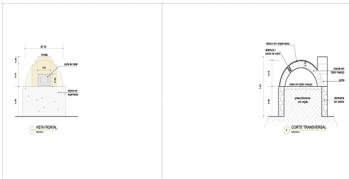
Figura 2: Desenhos ilustrativos do forno de barro, com as técnicas construtivas, dimensões e especificidades de materiais: Vista frontal (1) e Corte transversal (2). Trata-se de um registro arquitetônico de um dos fornos mais antigos existentes na região dos Três Picos; herança de processos tradicionais construtivos desenvolvidos pelas famílias de agricultores camponeses.
