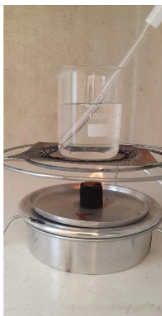
Figura 4: Montagem do sistema para a combustão simples.
