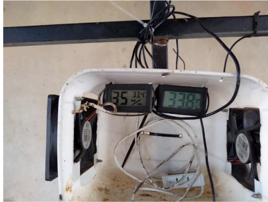
Figura 3 – Sensores usados para medir temperatura e umidade dentro de um curral para ovinos
