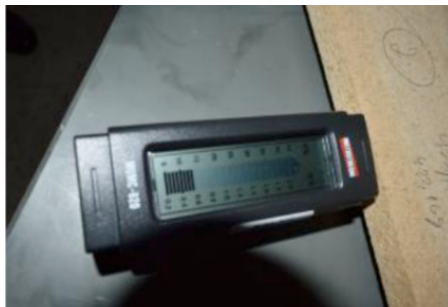
Figura 1. Medidor de umidade Instruthern Modelo MUMC- 620
