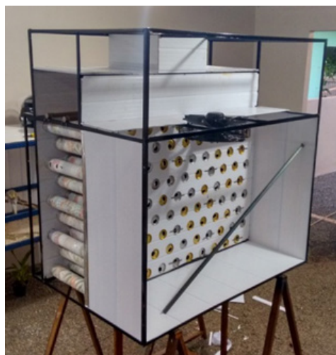
Foto 2 - Vista interna do climatizador.
