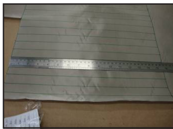
Figura 3- Malha metálica nas dimensões de corte para utilização como elemento resistivo para a soldagem dos laminados.
