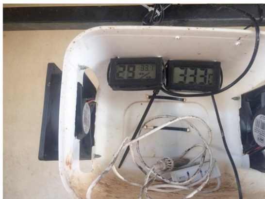
Figura 2 – Sensores usados para medir temperatura e umidade dentro de um curral para bovinos
