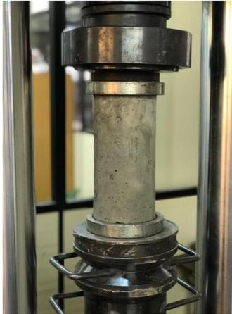
Figura 6- Ensaio de Resistência à compressão
