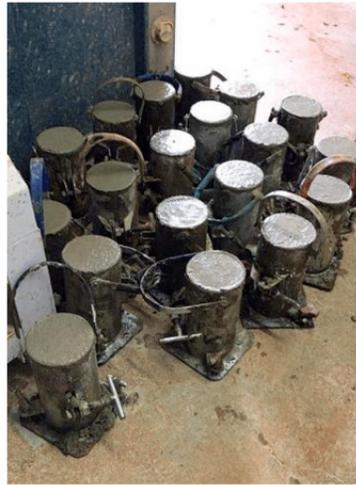
Figura 2 - Corpos de prova cilíndricos moldados
