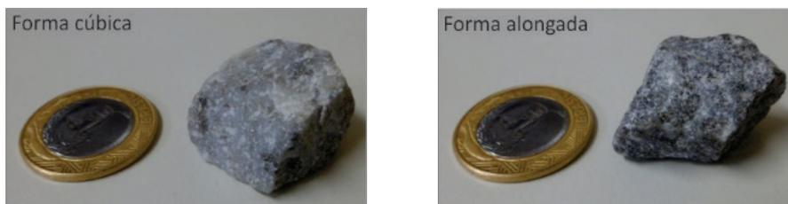
Figura 2 Forma cúbica e alongada do agregado graúdo
