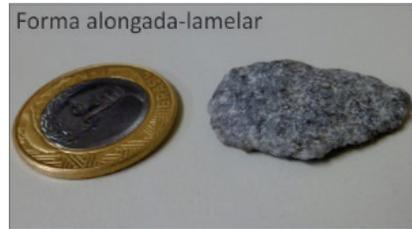
Figura 3 Forma lamelar e alongada-lamelar do agregado graúdo
