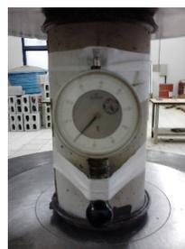
Figura 8 Ensaio Módulo.
