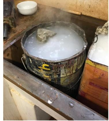
Figura 5 - Resfriamento rápido dos corpos de prova
