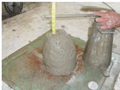
Figura 5 Abatimento do tronco de cone de Abrams.
