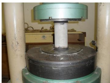
Figura 6 Ensaio à Compressão.
