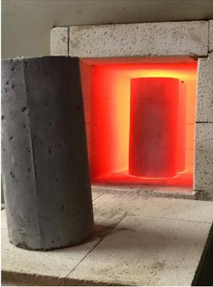
Figura 3 - corpos de prova sendo retirados da mufla
