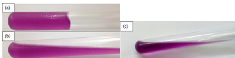
Figura 11. Teste da atividade proteolítica sob a formação da gelatina para: a) controle negativo b) controle positivo (Papaína livre) e c) papaína imobilizada
