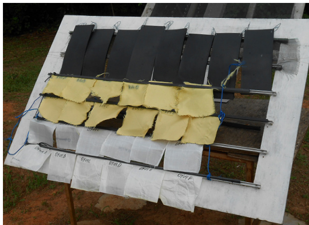
Figura 2 - Amostra de PEUAM e corpos de provas utilizados em exposição à intempérie
