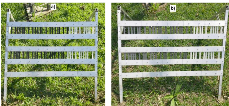
Figura 2 - Corpos de prova a) antes e b) depois do ensaio de degradação por envelhecimento natural.
