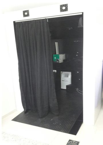
Fig. 9 Protótipo de teste da cabine sensorial 4 estações.
