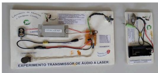
Fig. 5 – Transmissor de áudio a laser.
