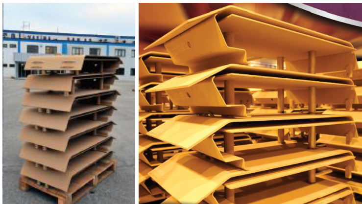
Figura 7: placas de blindagens add-on espaçadas.
