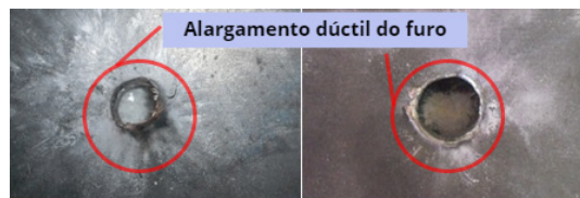
Figura 20: placas de aço dos módulos perfuradas.
