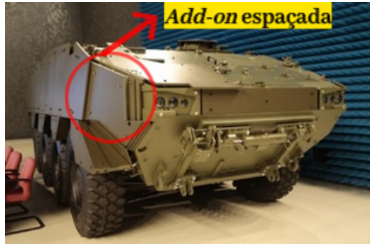
Figura 2: ensaio realizado com blindagem espaçada.
