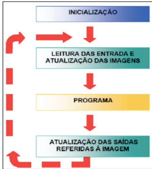
Figura 4 – Processamento do CLP (ciclo)
