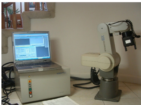
Figura 1. Manipulador Mitsubishi Movemaster RV-M1.
