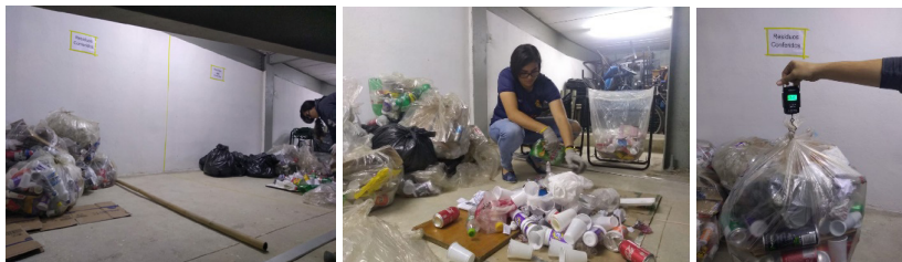
Figura 3 – a) Separação dos materiais conferidos e não conferidos; b) Conferência dos materiais; c) Análise gravimétrica.
