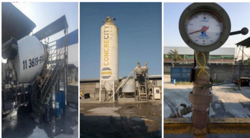
Figura 3 (A) Processo de dosagem do concreto; (B) Dosador de água; (C) Dosagem de água
