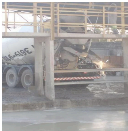
Figura 2: Lavagem dos caminhões betoneira
