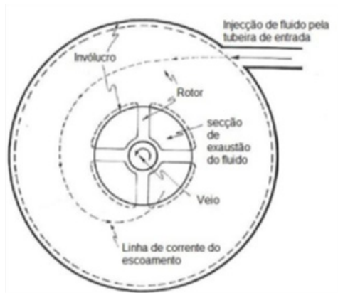
Figura 4 - Trajetória do fluido na turbina de Tesla.
