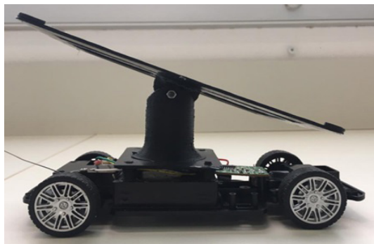
Figura 3 - Carrinho solar com painel orientável
