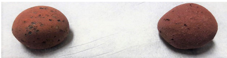
Figura 13 - Argila expandida elaborada
