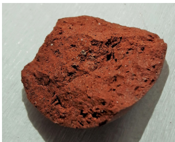
Figura 17 - Porosidade da argila expandida devido à incorporação de serragem – 2º ensaio
