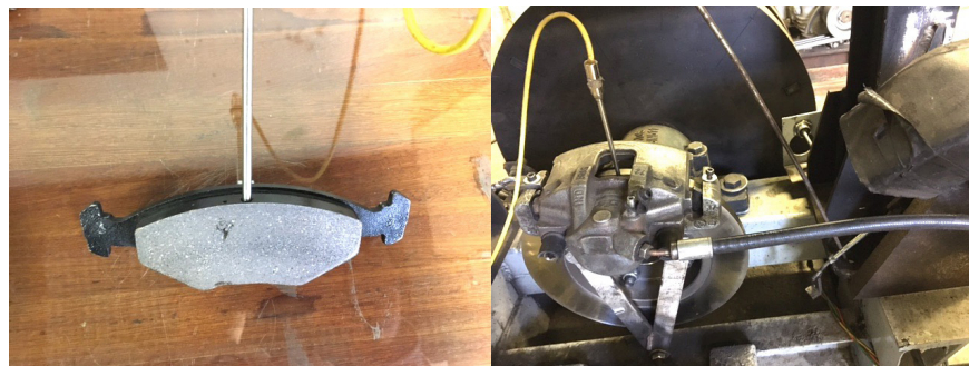
Figura 42 Posicionamento do termopar no sistema de freio.
