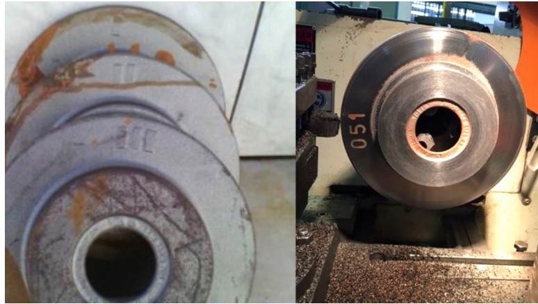
Figura 41 Discos no estado bruto de fundição e durante a usinagem.
