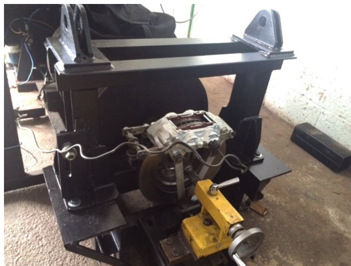
Figura 14 Estrutura em arco com suporte para célula de carga.
