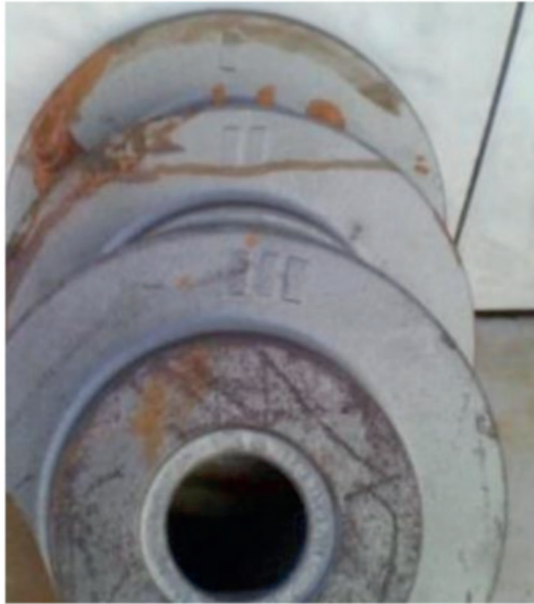
Figura 39 Discos, estado bruto de fundição, usados nos ensaios de frenagem, identificados como I, II e II; e depois nomeados como: Fe250, FeTi; e FeAC; respectivamente.
