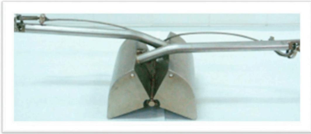
Figura 4. Apresentação da estrutura do Amostrador Van Veen.
