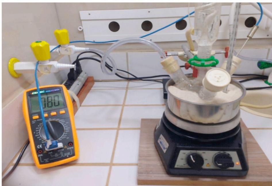
Figura 1. Montagem experimental (*Set-Up*) do sistema utilizado para desenvolver a síntese das nanopartículas de Bi/Bi<sub>2</sub>O<sub>3</sub>.
