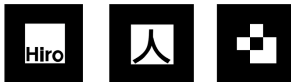
Figura 7. Marcadores usados no A-frame: hiro, kanji e o qr code #20.
