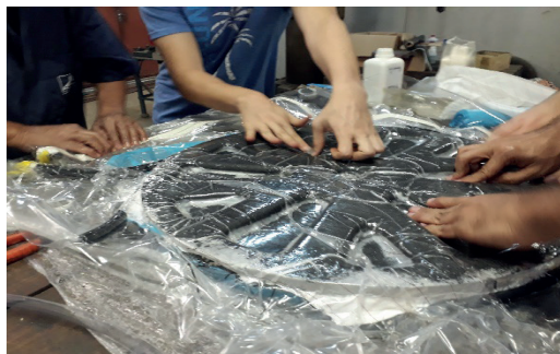
Figura 5 – Processo de laminação manual da roda com o auxílio da bolsa à vácuo
