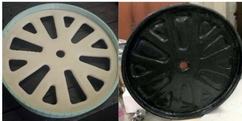
Figuras 12 e 13 – Roda: escopo artesanal de Divinycell e peça final laminada, respectivamente Fonte: GOMES, Karina. Escola de Engenharia UFF – Rio de Janeiro, Brasil (abril, 2019)
