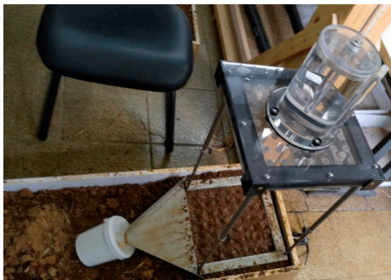
Figura 1 – Experimento em funcionamento com simulador de chuva Eijkelkamp
