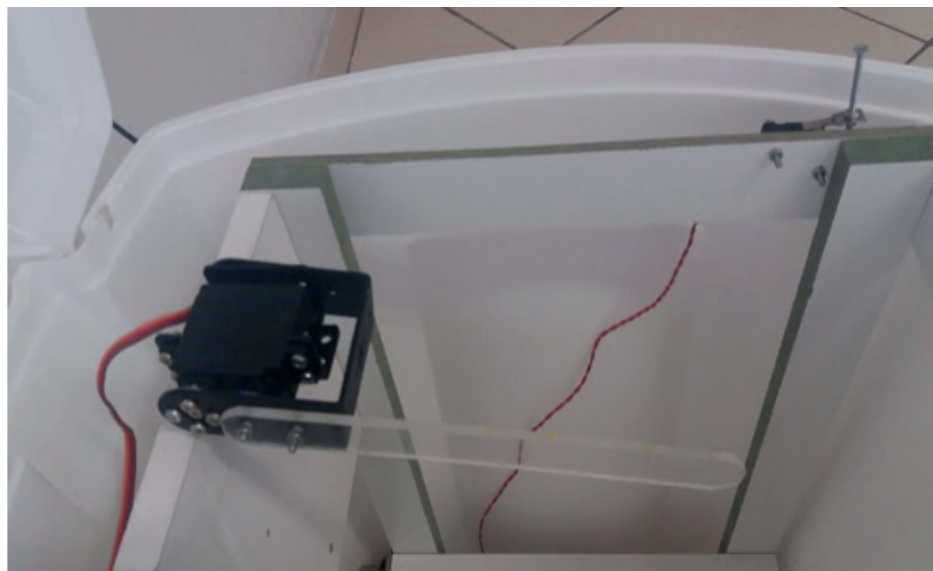
Figura 9 – mecanismo para abertura da tampa.
