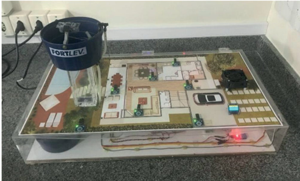
Figura 11 – Maquete educacional de uma residência automatizada.
