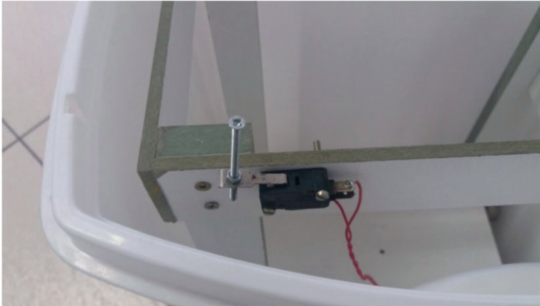
Figura 10 – sensor de abertura e fechamento da tampa.
