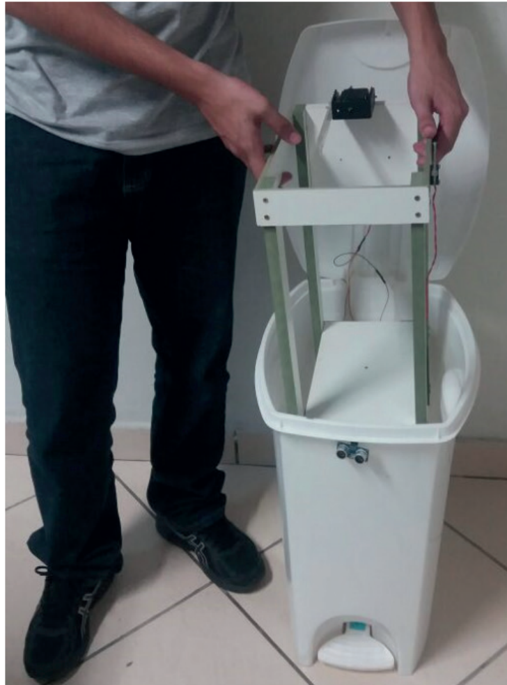
Figura 4 – acondicionamento da estrutura na lixeira.
