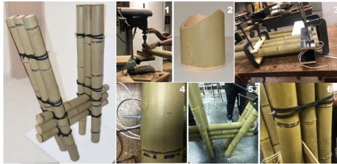
Figura 5. Modelo finalizado do detalhe da cobertura de bambu, etapas 1, 2, 3, 4, 5, 6: Fotos do processo de execução do modelo
