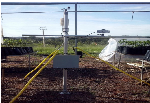
Figura 7. Estação micrometeorológica acoplada com sensores de radiação, temperatura e umidade relativa no interior de um telado agrícola. Cassilândia-MS, 2017.
