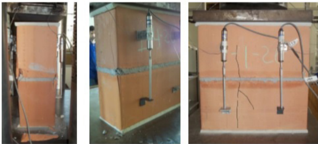
Figura 5 - Modo de ruptura dos prismas cerâmicos de dois blocos da série Ce (não grauteados)
