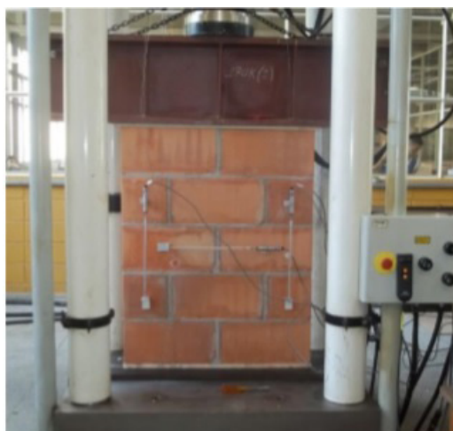
Figura 4 - Esquema de ensaio da resistência à compressão das pequenas paredes cerâmicas
