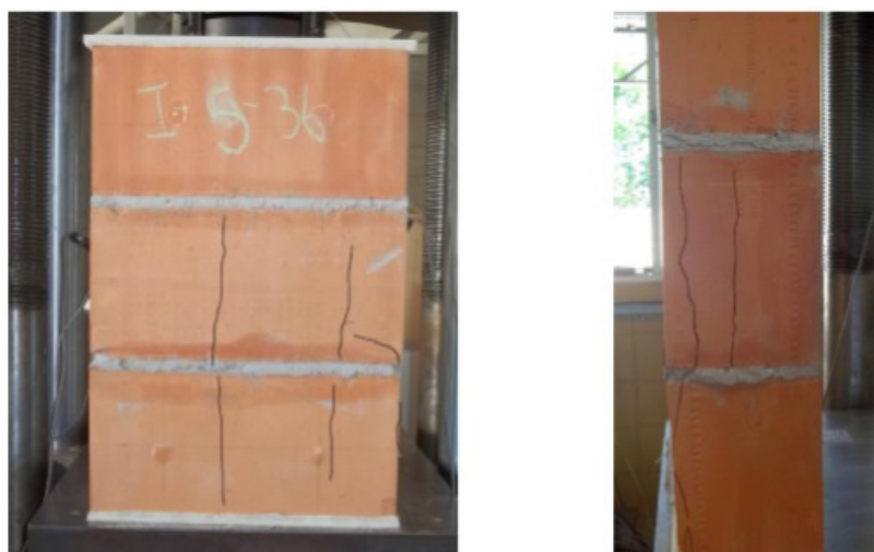
Figura 9 - Modo de ruptura dos prismas cerâmicos de três blocos da série Ce (não grauteados)
