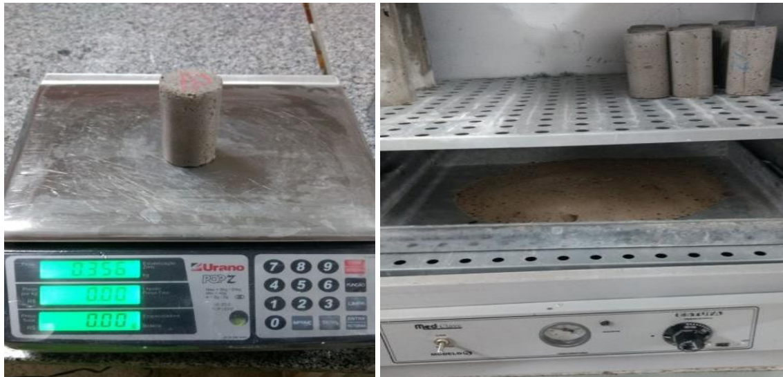
Figura 7 – Ensaio de absorção de água, índices de vazios e massa específica. (Autor (2017))
