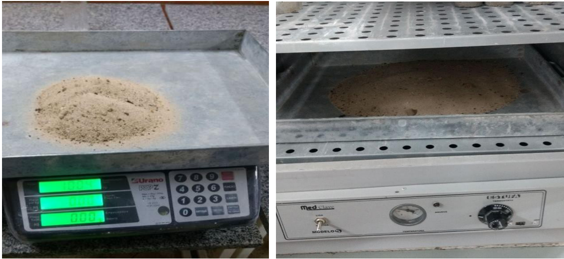
Figura 2 – Pesagem e Secagem das amostras de areia fina. (Autor (2017))
