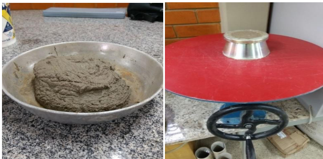
Figura 4 – Argamassa preparada e Molde troncônico preenchido. (Autor (2017))
