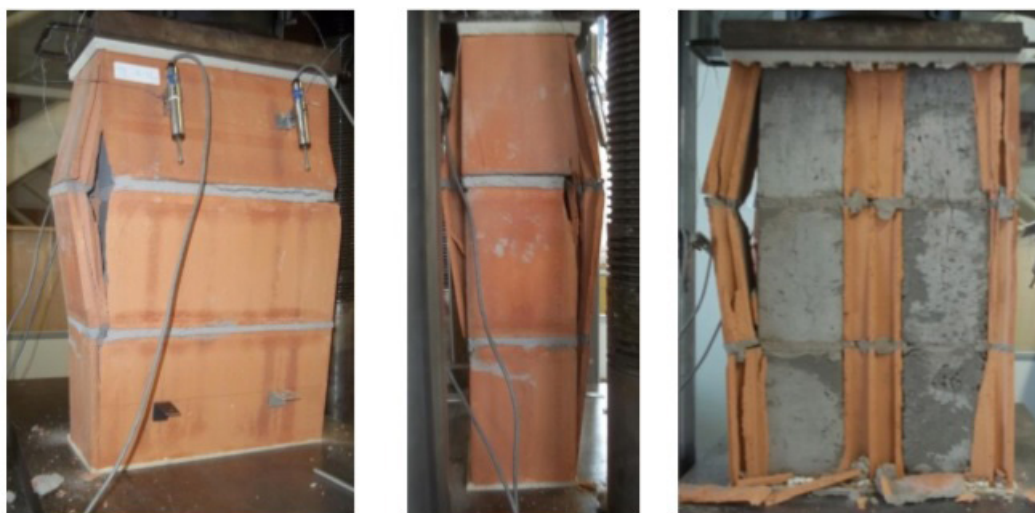
Figura 10 - Modo de ruptura dos prismas cerâmicos de três blocos da série CeG30 (graute G30)
