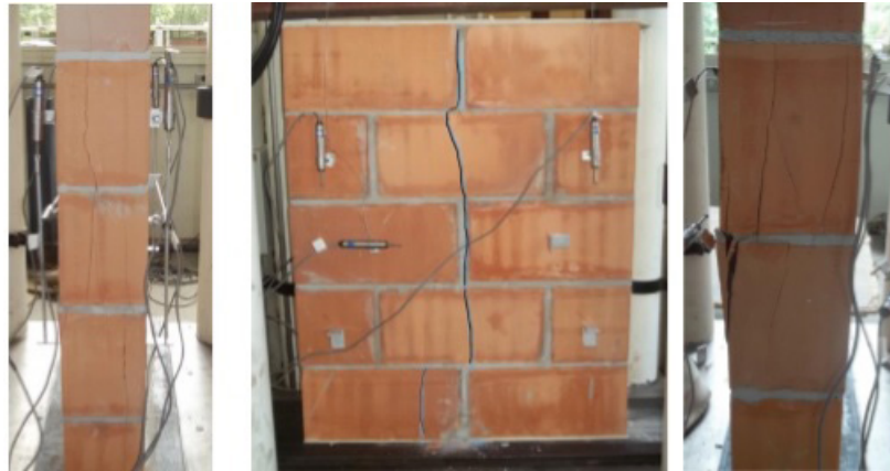
Figura 15 - Modo de ruptura das pequenas paredes cerâmicas da série CeG14 (graute G14)
