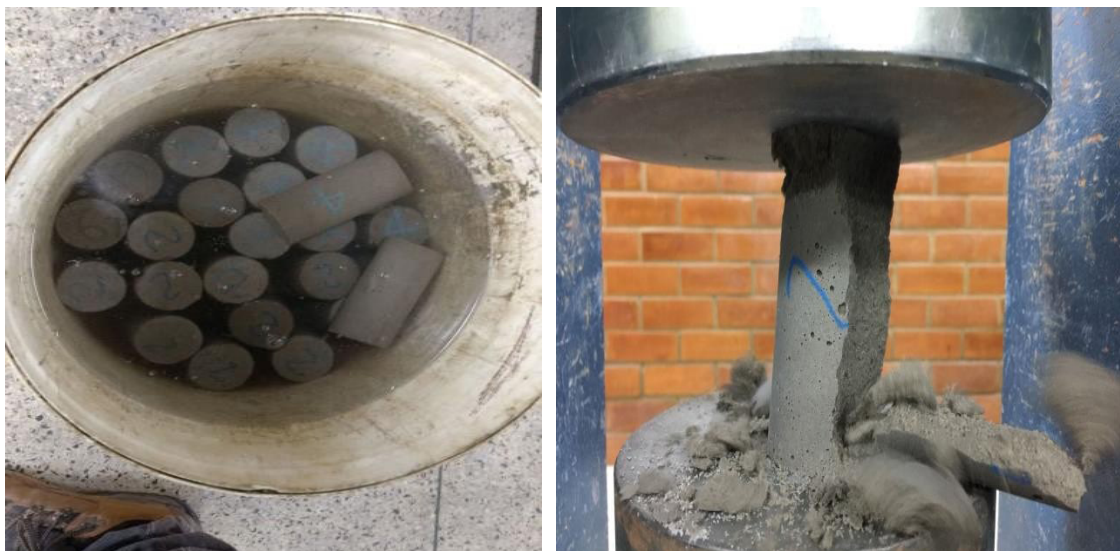
Figura 6 – Cura e Rompimento de corpos de prova. (Autor (2017))
