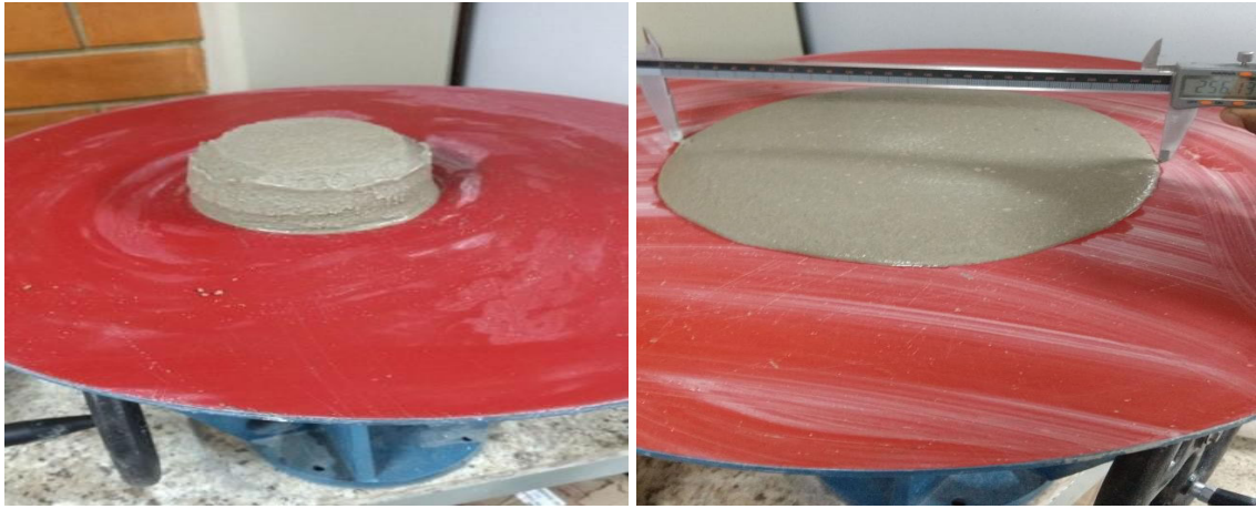
Figura 5 – Argamassa após retirada do molde e Medição do diâmetro de espalhamento. (Autor (2017))
