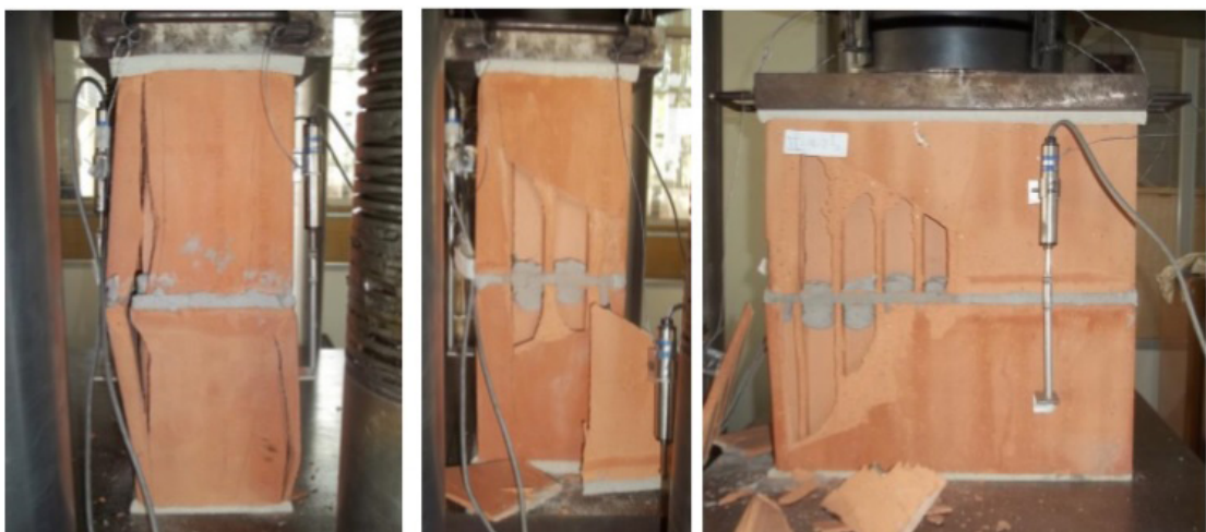
Figura 6 - Modo de ruptura dos prismas cerâmicos de dois blocos da série CeG14 (graute G14)
