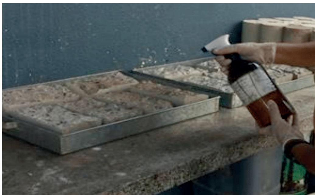
Figura 6–Aspersão de AgNO 3 nos corpos de prova
