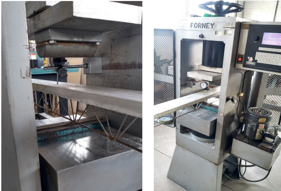
Figura 5 – Viga sendo preparada para ensaio
