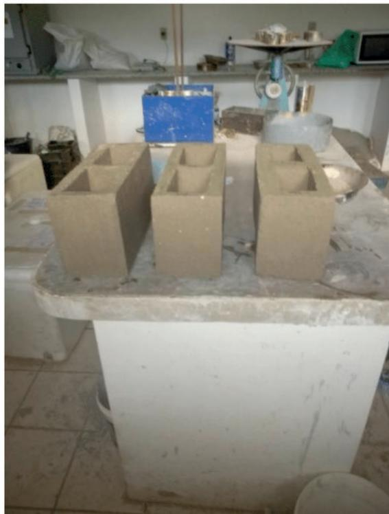
Figura 4 – Blocos após saturação.
