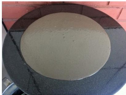
Figura 5 - Argamassa após o teste de espalhamento.
