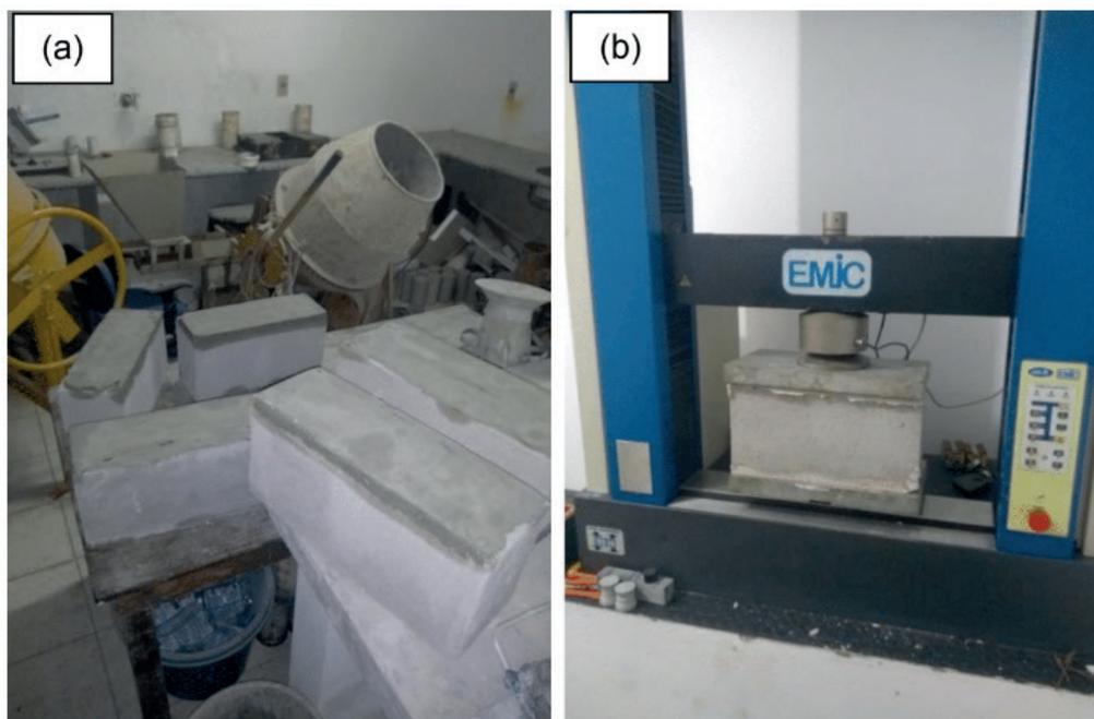
Figura 3 – Blocos após o capeamento (a) e durante ensaio de resistência à compressão (b).
