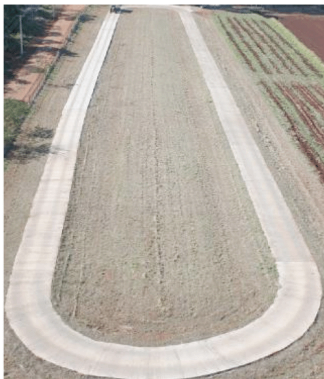
Figura 1- Pista padronizada para ensaios de tratores.
