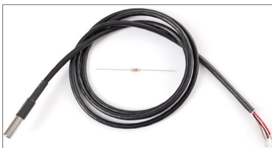
Figura 6 - Sensor de Temperatura DS18B20
