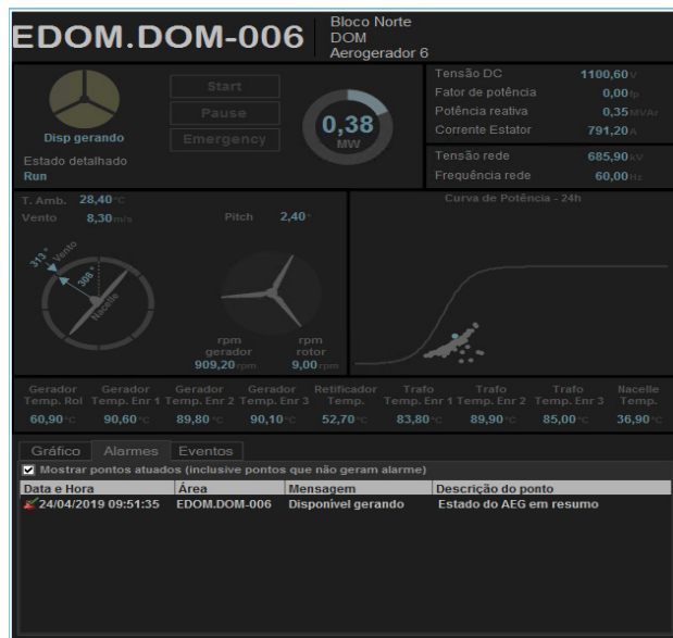
Figura 7. Tela de detalhamento do aerogerador no SCADA (Autor, 2019)
