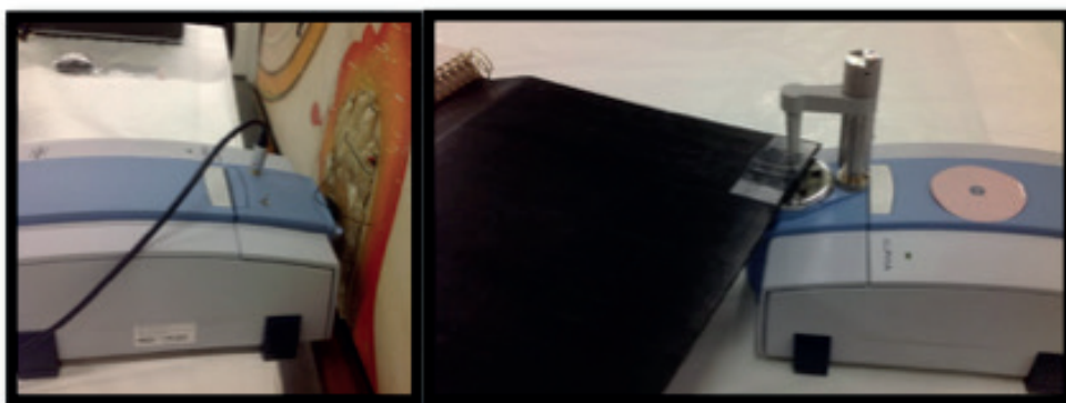
Figura 3. Equipamento Alpha Spectrometer Bruker® utilizado na aquisição de medidas. Módulos ATR (direita) e Reflectância (esquerda). Fonte: própria.
