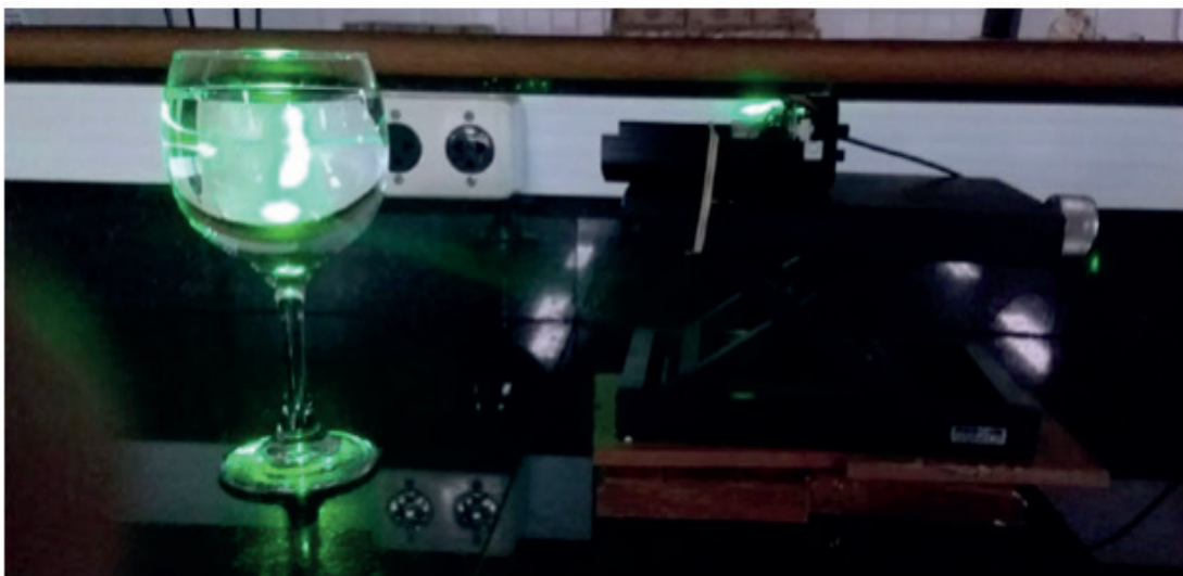
Figura 3. Fotografia do experimento realizado para observação do raio cartesiano. Fonte: Autoria própria.
