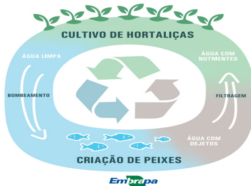
Figura 1. Integração entre criação de peixes e hidroponia. Fonte: Carneiro et al., 2015.
