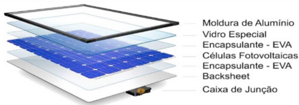
Figura 1 - Composição de um painel fotovoltaico
