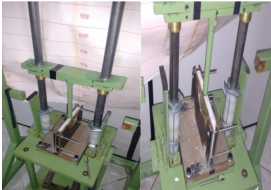
Figura 17: dispositivo de ensaio acoplado à máquina de impacto.
