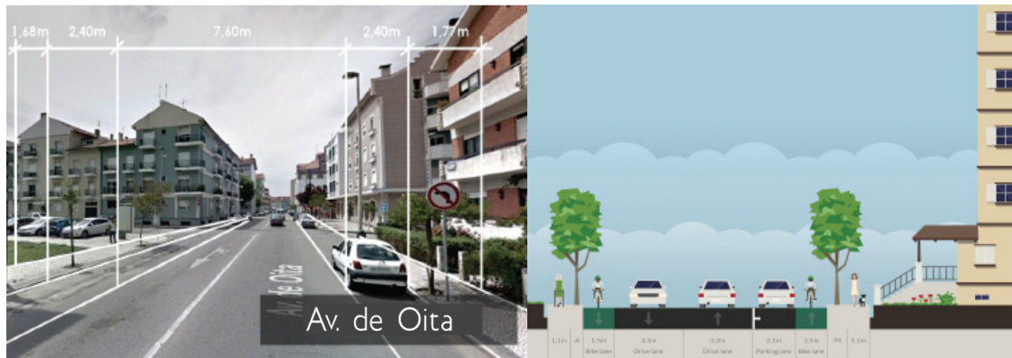
Fig. 5: Perfil viário existente da Avenida de Oita.
