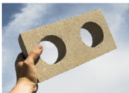
Figura 2. Bloco prensado com núcleo oco
