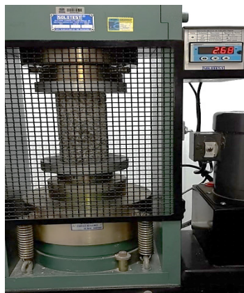
Figura 5 – corpo de prova em prensa hidráulica para teste à compressão
