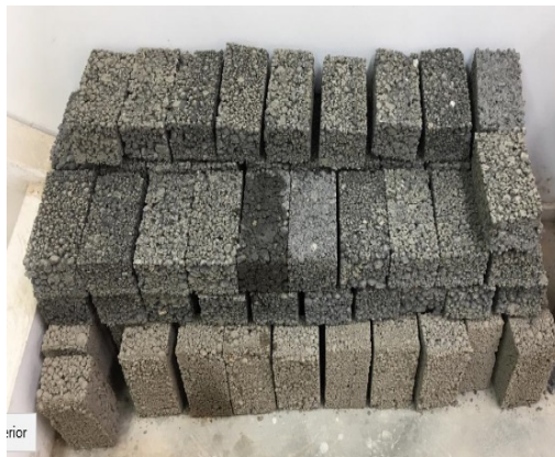
Figura 3 – Peças de concreto final de pavimentação drenante
