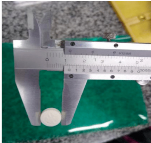
Figura 4: Paquímetro utilizado para medir o diâmetro dos comprimidos em teste.
