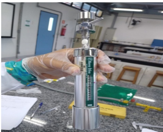
Figura 3: Durômetro sendo utilizado.
