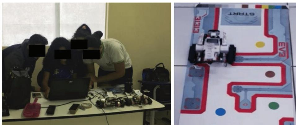
Figura 7 – Atividade de programação do robô para seguir uma trajetória especificada. À esquerda estudantes programando o robô. À direita robô seguindo a trajetória programada.
